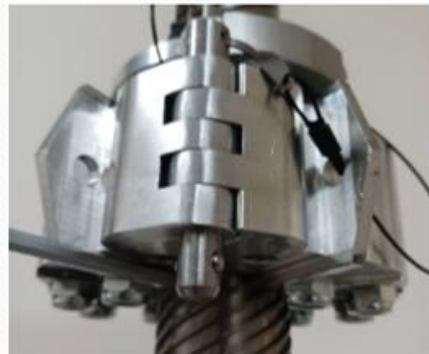
螺母夾合螺杆 止擋插銷避免移動
